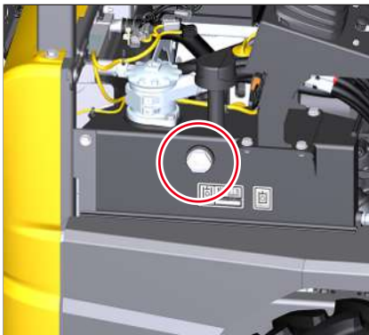
Fig. 127: Controlar el nivel de aceite hidráulico
