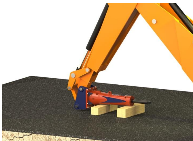
Ilustración 8: Colocación sobre terreno firme y nivelado.
