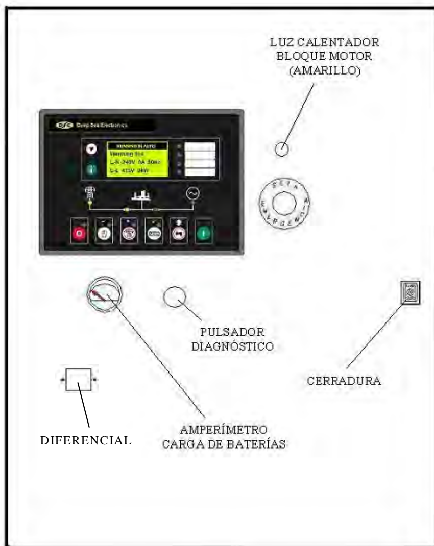
Imagen 6 - Cuadro de Control de Placa de Control DeepSea
