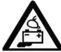
Imagen 23 Posible derrame batería
