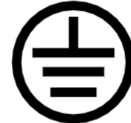
Imagen 24 Toma de tierra
