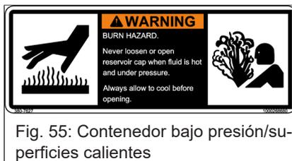
Fig. 55: Contenedor bajo presión/superficies calientes
