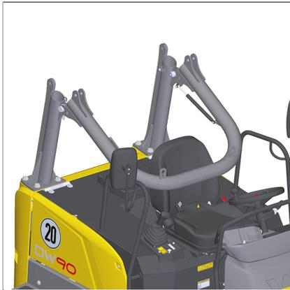
Fig. 87: Barra antivuelco plegada hacia abajo
