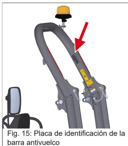
Fig. 15: Placa de identificación de la barra antivuelco
