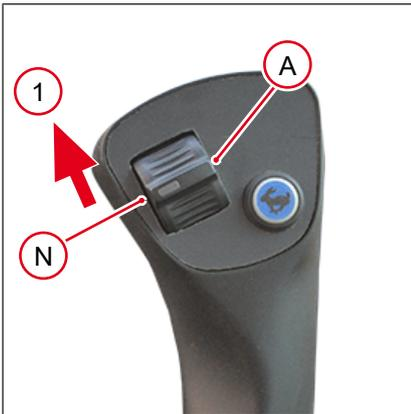
Fig. 103: Control de funcionamiento del sensor de ocupación de asiento
