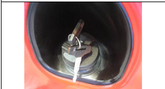
La tapa del depósito de combustible lleva cerradura (Sólo aplicable al vehículo LPG de combustible simple 4-x5.5t W57)
