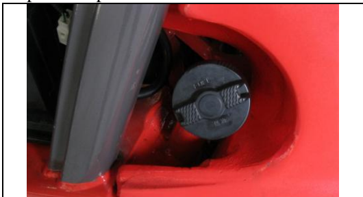
La tapa del depósito de combustible no lleva cerradura.
