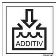
Llenado del depósito de agua de rociado con aditivos
