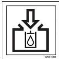
Llenado del depósito de aceite hidráulico
